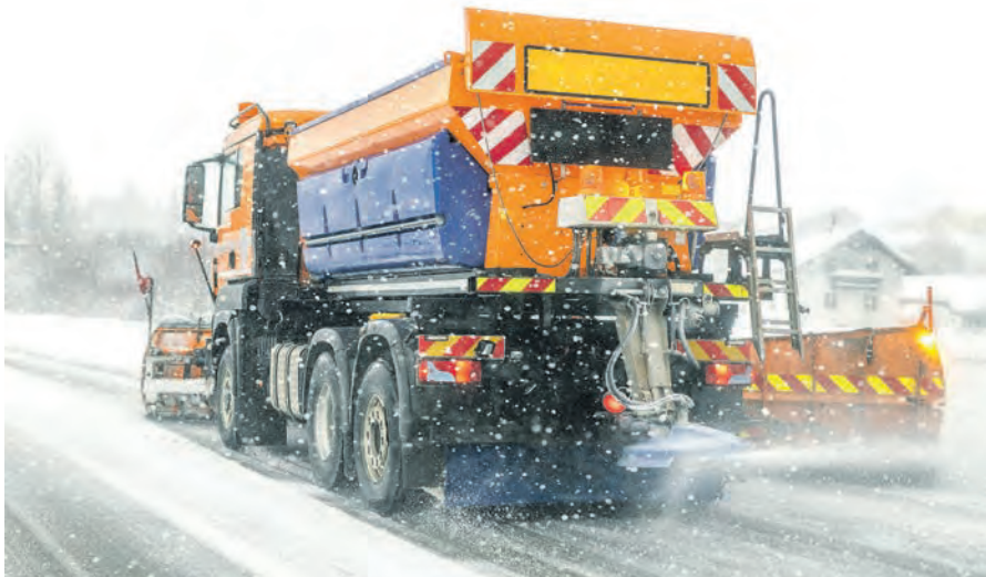
Mobil trotz Schnee und Eis: Dank moderner Kombinationsstreuung kann der Winterdienst je nach Bedarf Feuchtsalz oder Sole ausbringen.
